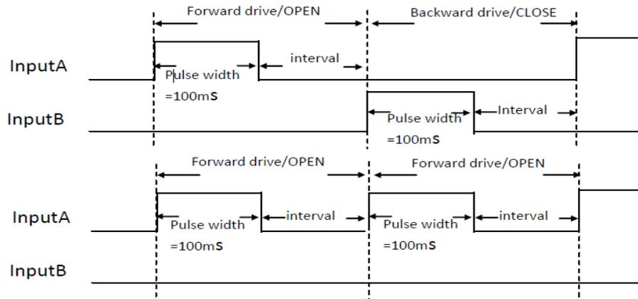
当 A、B 同为高或低时继电器处于保持状态，无动作。BL8023H 内部 A、B 口均接有约 500K 的下拉电阻，通常可以不外接下拉电阻。但某些 MCU 如 51 核心的单片机或炬泉 SOC 其上电复位完成前或端口未配置成输出时 I/O 内部有弱上拉，这种情况下 MCU 复位完成前或程序运行前 I/O 口可能产生无效高电平，造成继电器误动作，此时需在 A、B 口接阻值为 4.7K-10K 的下拉电阻，如图中所示的 R5、R6。
